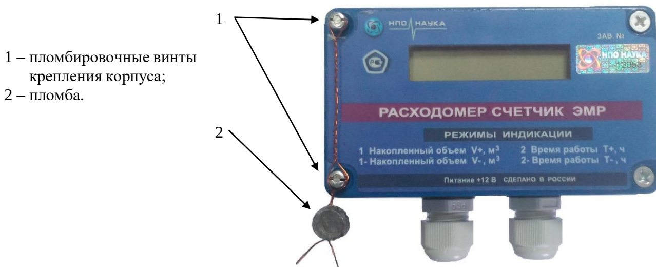
Рисунок 4.4 - Схема пломбировки расходомеров
