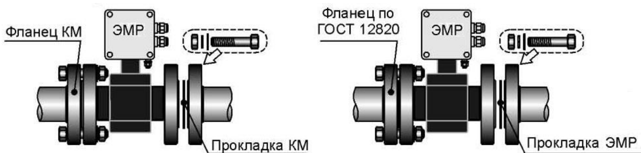
Рисунок 6.7 – Варианты монтажа ЭМР
